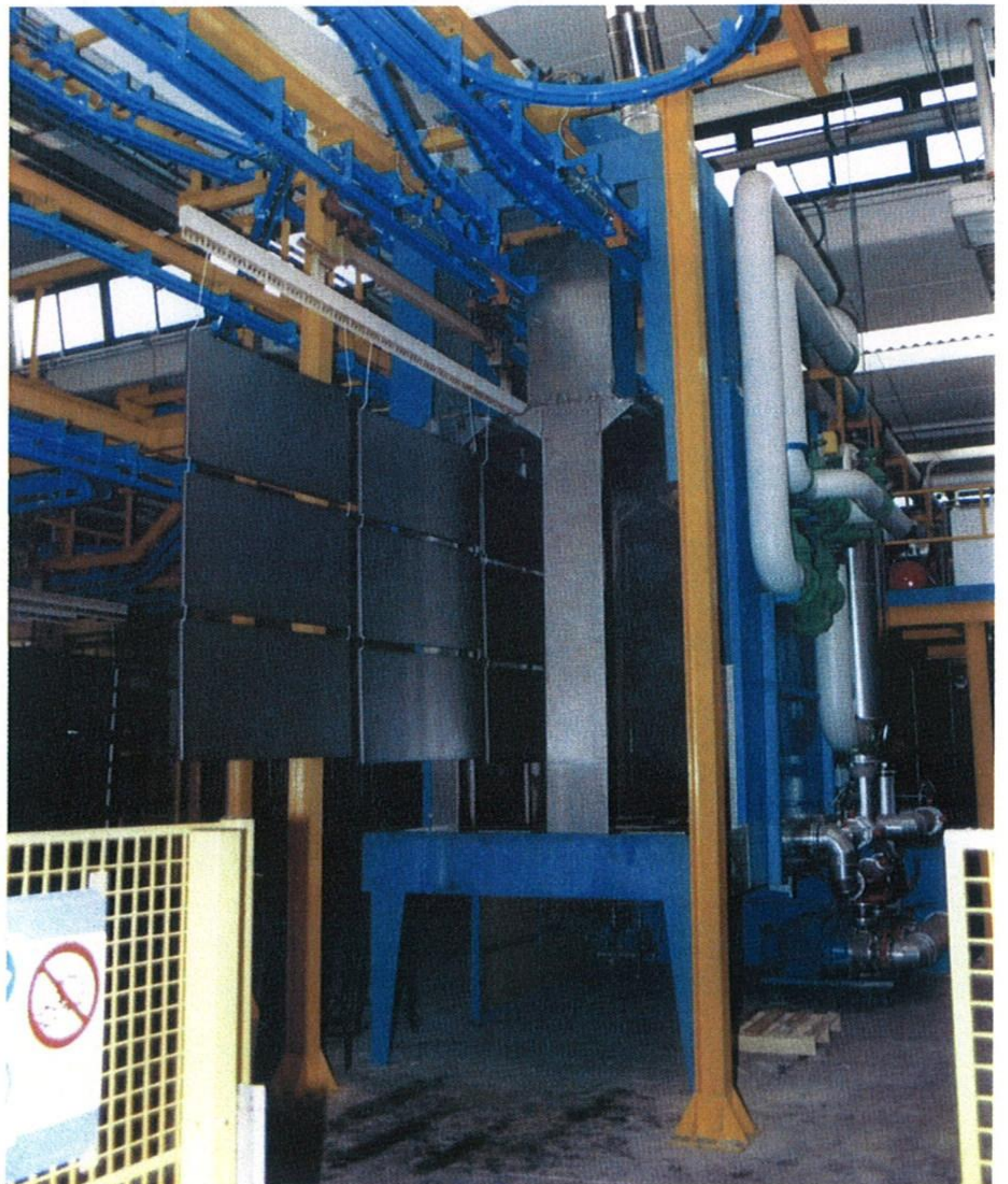
Fig. 6 -Le due bocche d'entrata del tunnel di pretrattamento fosfatico, capace di dare una produzione doppia rispetto al tradizionale passaggio singolo dei pezzi
