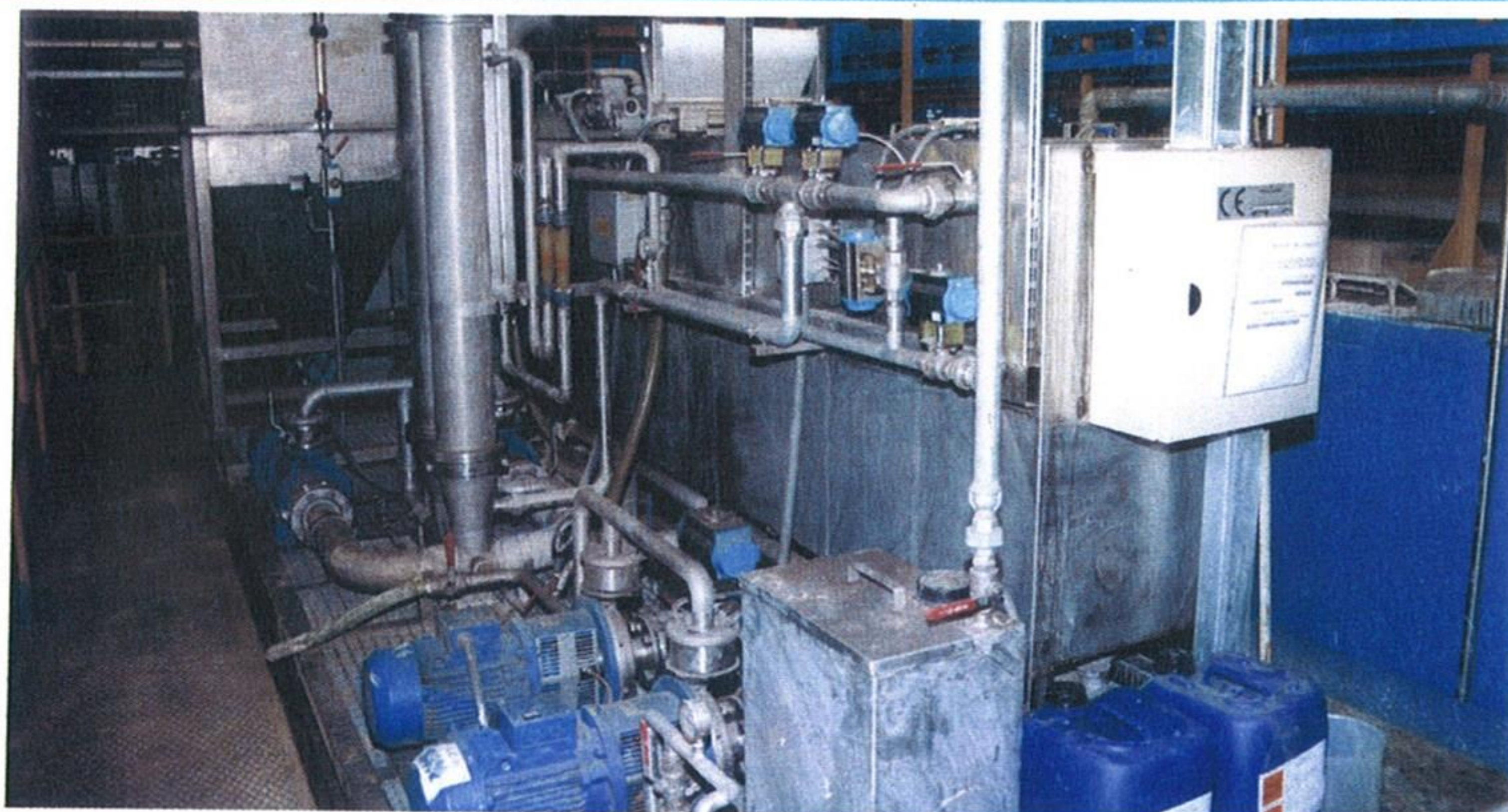
Fig. 15 - L'unità di ultrafiltrazione in continuo, associata al grande tunnel di fosfosgrassaggio, in dotazione al nuovo impianto di verniciatura degli arredamenti metallici
