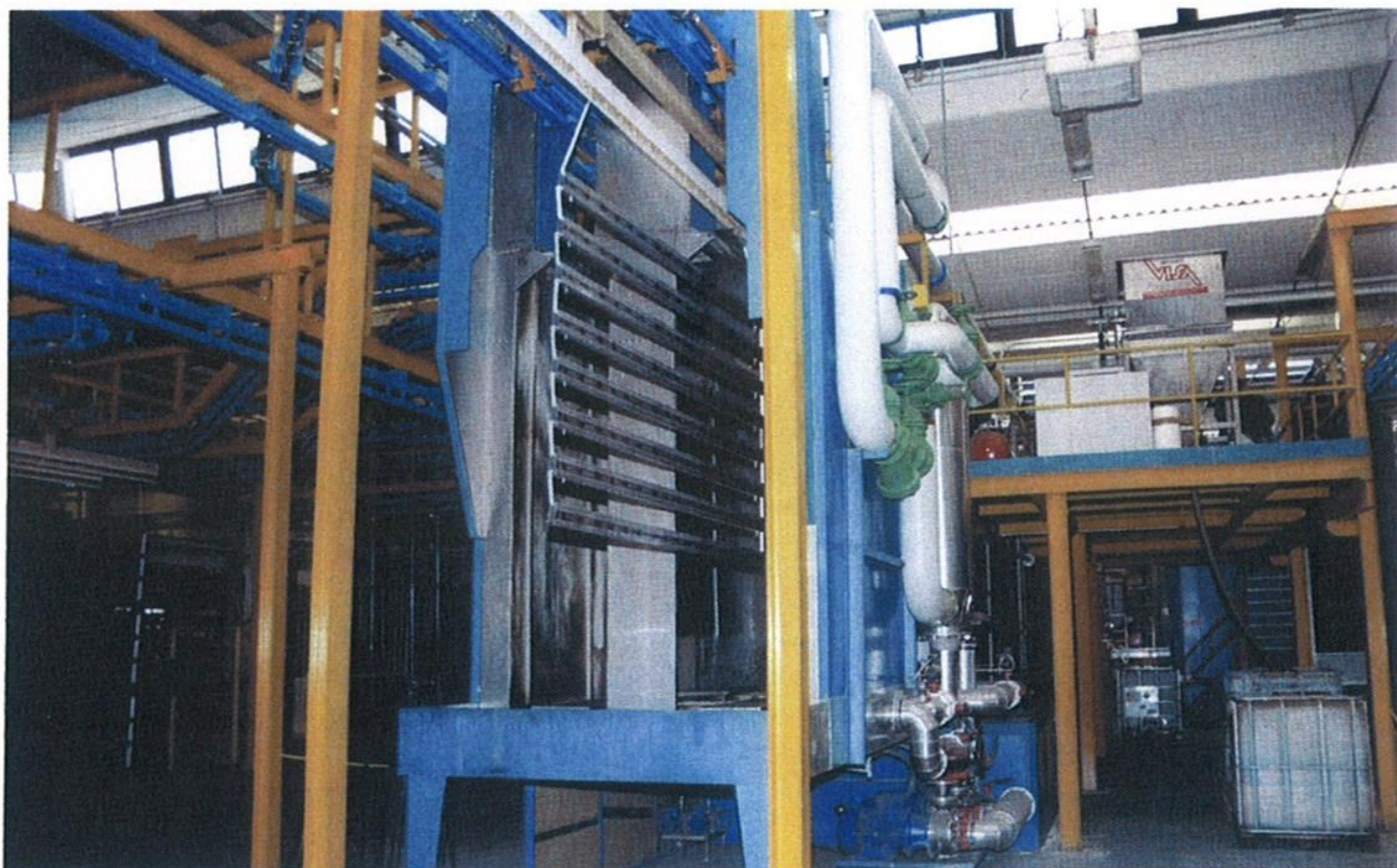
Fig. 7 - I pezzi fosfosgrassati all'uscita del tunnel di pretrattamento metallico
