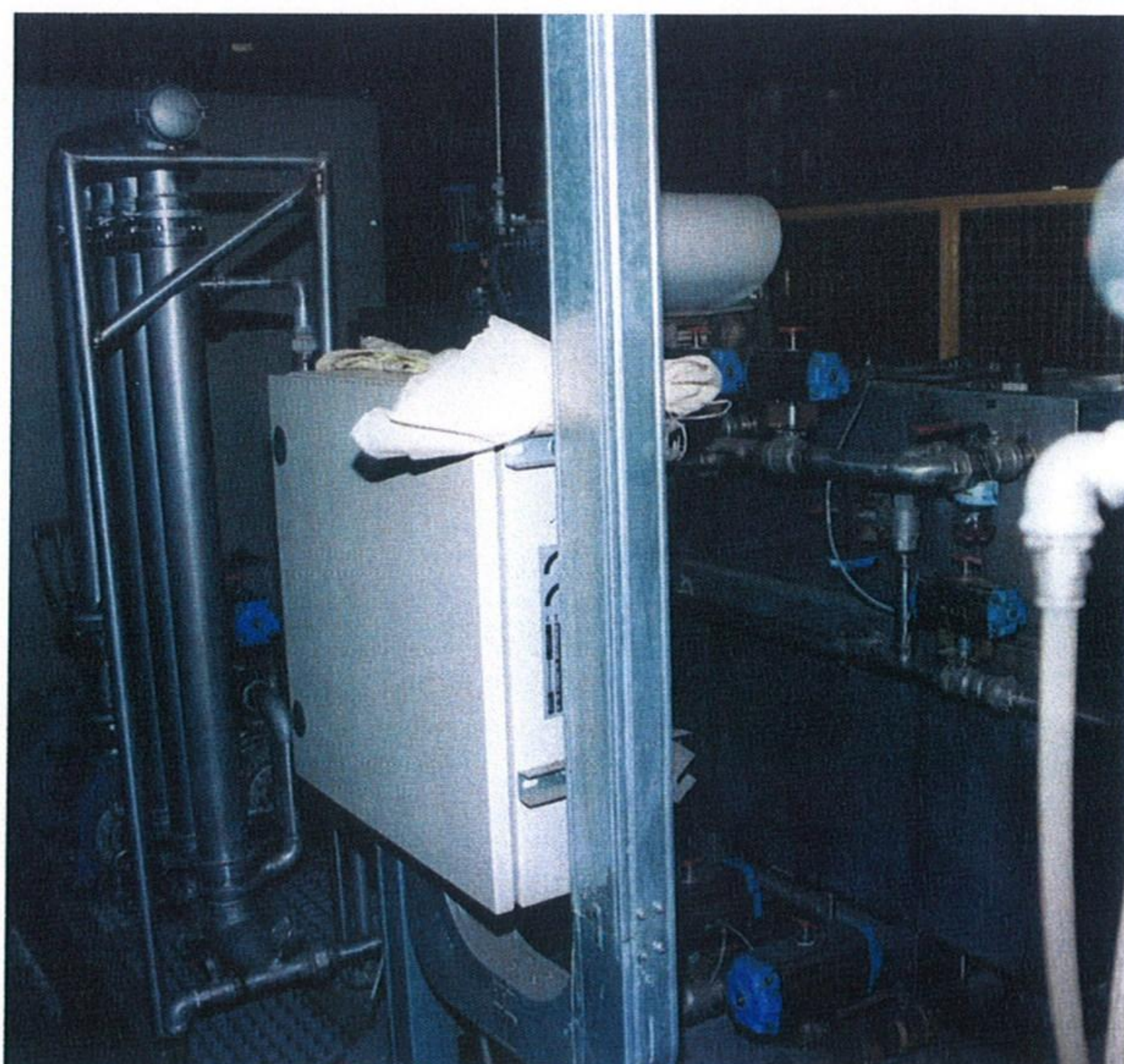
Fig. 12 - Le apparecchiature di trattamento, a scarico zero, delle acque di processo fosfosgrassante nel piccolo impianto sulla linea "casse"
