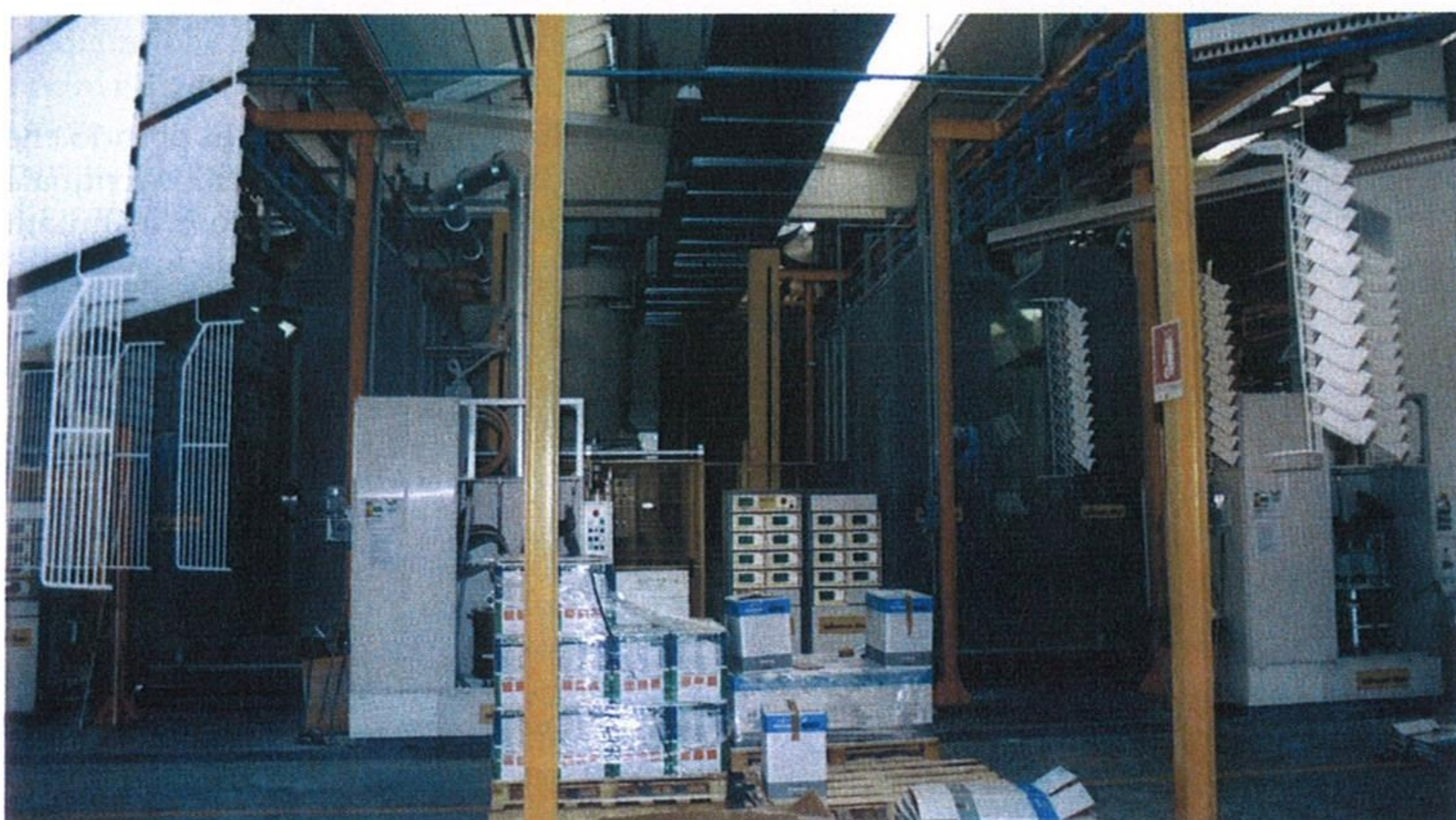
Fig. 22 - Due delle tre cabine di spruzzatura delle polveri, di notevole resa elettrostatica
