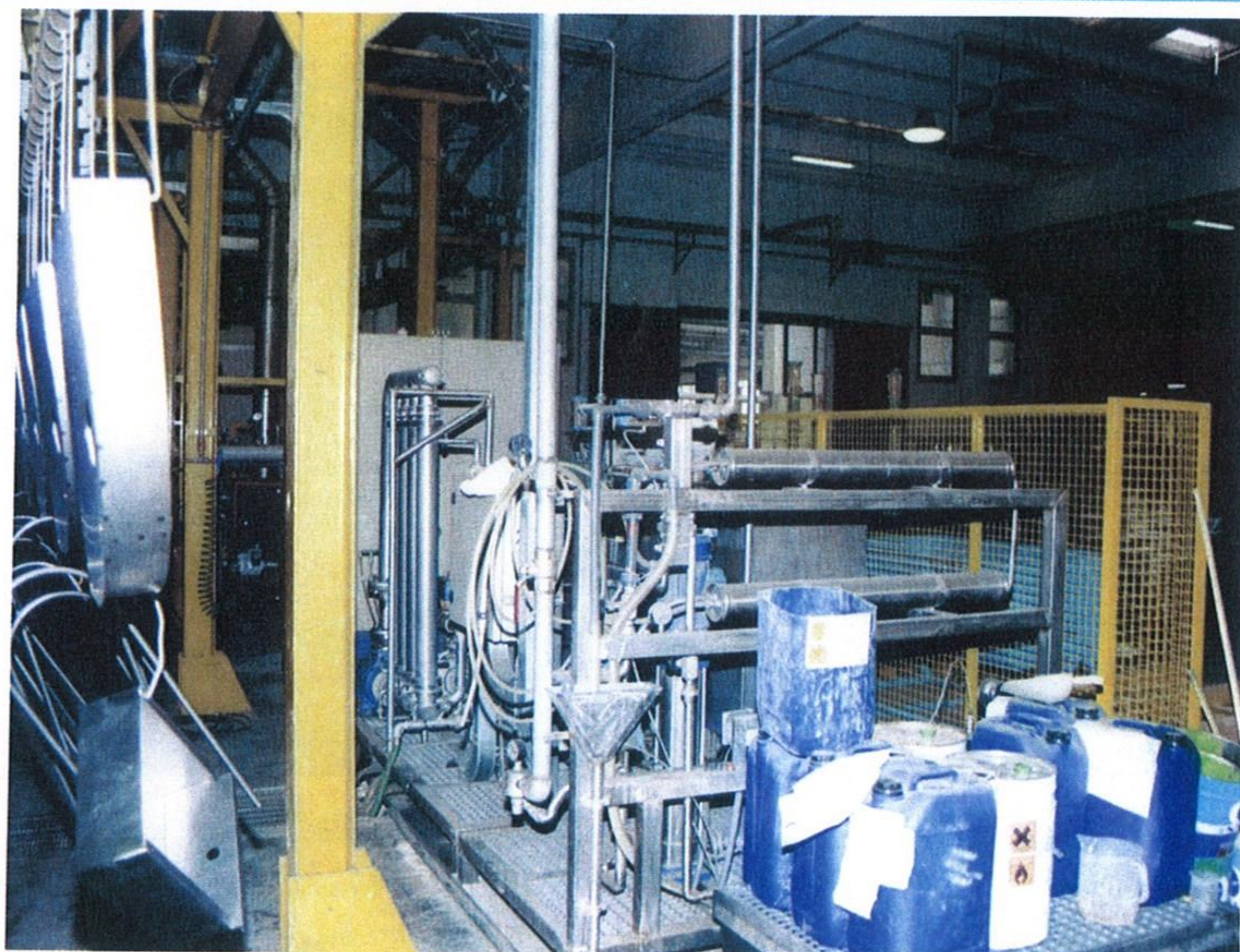
Fig. 13 - In primo piano si notano i tubi dell'apparecchiatura di osmosi inversa del "piccolo impianto casse"
