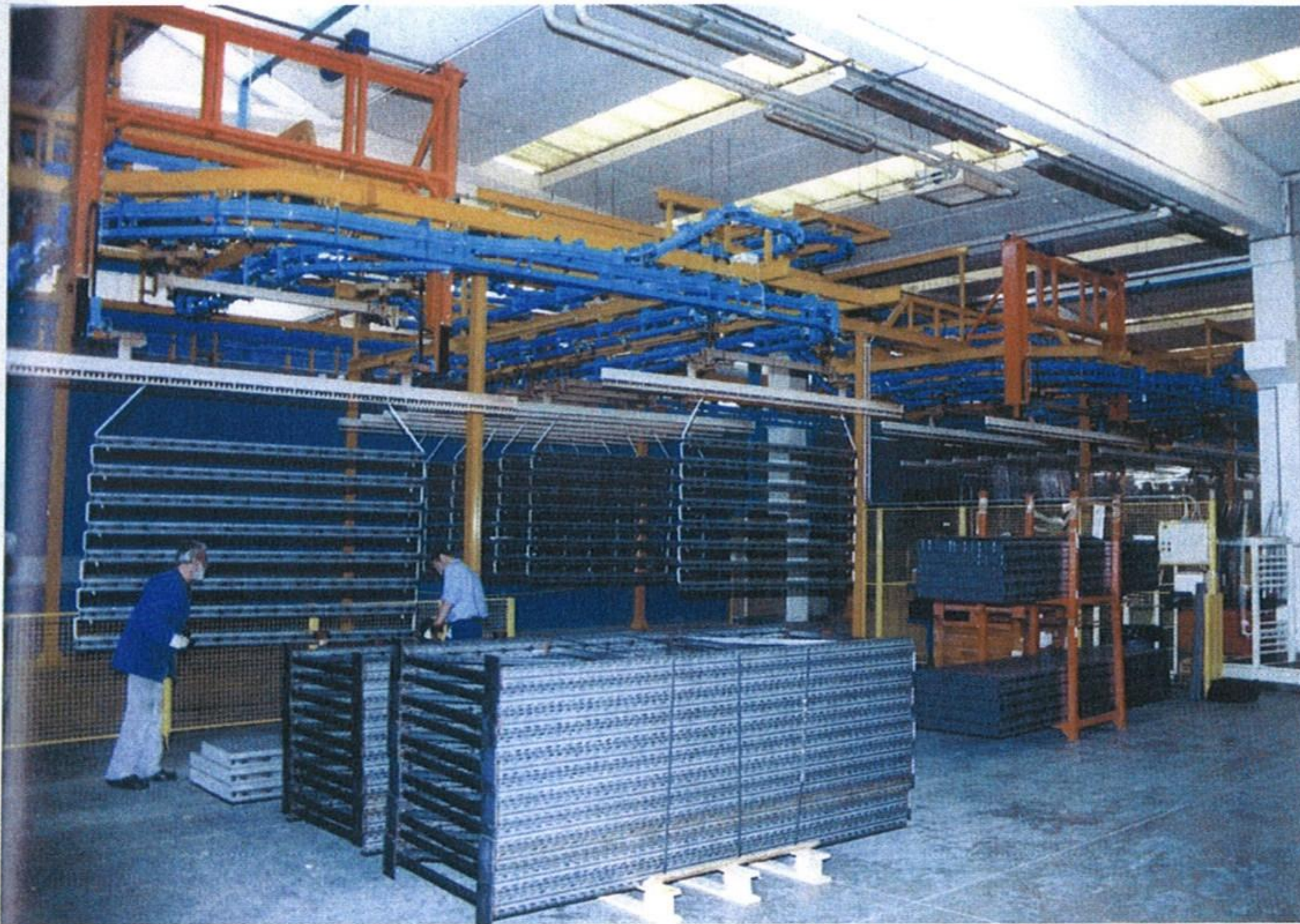
Fig. 6 -Le due bocche d'entrata del tunnel di pretrattamento fosfatico, capace di dare una produzione doppia rispetto al tradizionale passaggio singolo dei pezzi
